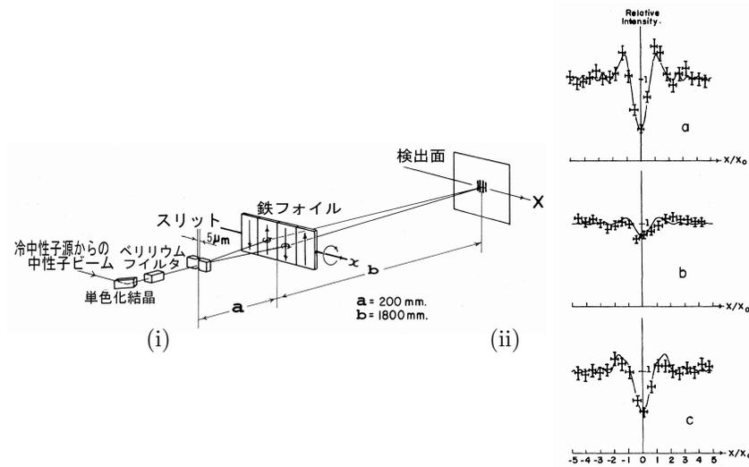
図 3.19: スピン 1/2 系に対する回転の効果を示す中性子ビーム実験: (i) 装置配置概略図. (ii) スピン歳差相対角; a)  $9.2 \times 2\pi$  rad, b)  $10.2 \times 2\pi$  rad, c)  $11.2 \times 2\pi$  rad, の中性子干渉フレネル (Fresnel) 回折模様 (Klein and Opat [164]).
