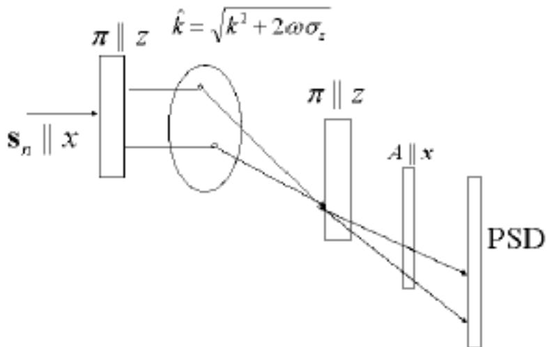
図 3.14: 非干渉性散乱体に対して記録する中性子ホログラムの実験概要. 第一  $\pi$ -スピニ反転器の後に生成される干渉性 SPW が試料により散乱される. 第二スピニ反転器と解析器の後, ホログラムが PSD により記録される.
